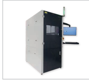
EVG*540 全自動ウェーハ接合装置 300mmまでの基板に対応
